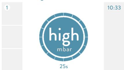
La pressione misurata è superiore a 400 mbar. La pompa si ferma automaticamente e viene mostrato il valore "High".
